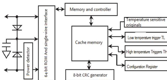
Fig. 2. DS18B20 internal structure diagram.
