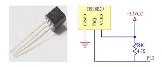
Fig. 3.DS18B20 temperature module.
