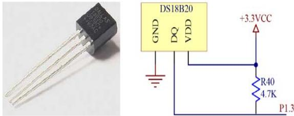
Fig. 3. DS18B20 temperature module.
