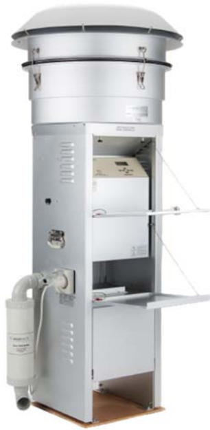
Fig. 5. A picture of the HiVol HVS3000 particulate sampler [22].
