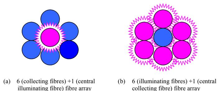
Fig. 6. Fibre array layout.
