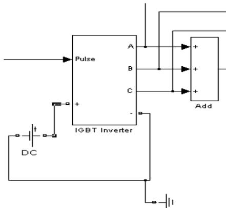
Fig. 4. Voltage inverter module.
